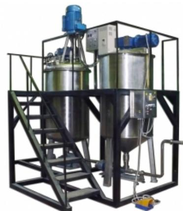
Диссольвер является основным технологическим оборудованием по производству шпаклевки.
